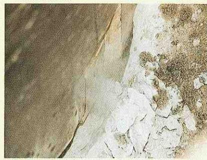
▲一軸圧縮強度 $2000\text{kgf/cm}^2$ の花崗岩の切削状況
