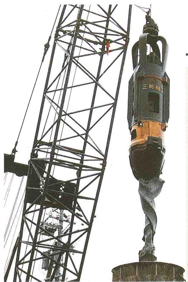
都市の再開発プロジェクト、橋梁・鉄塔などの建替工事など、近年、鉄筋コンクリート基礎・PCパイル・H鋼杭・钢管杭などの障害物が取り残されたままの地盤をケーシングにより掘削することが頻繁に行われています。
