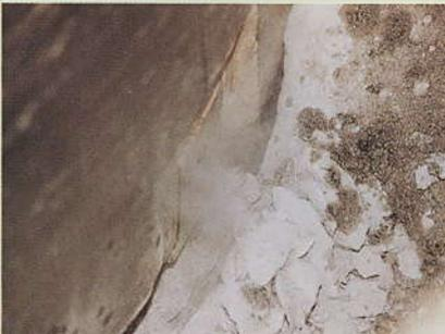
▲一軸圧縮強度196MPa(2,000kgf)/cm<sup>2</sup>の花崗岩の切削状況
